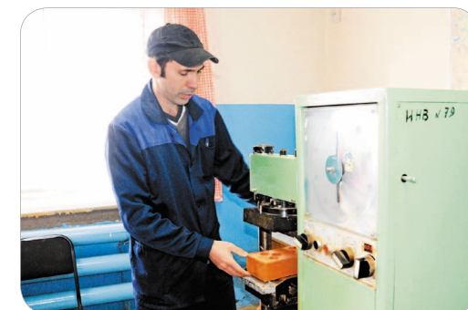
Проверка кирпича на прочность в лаборатории ООО «Кирпичный завод СК»
